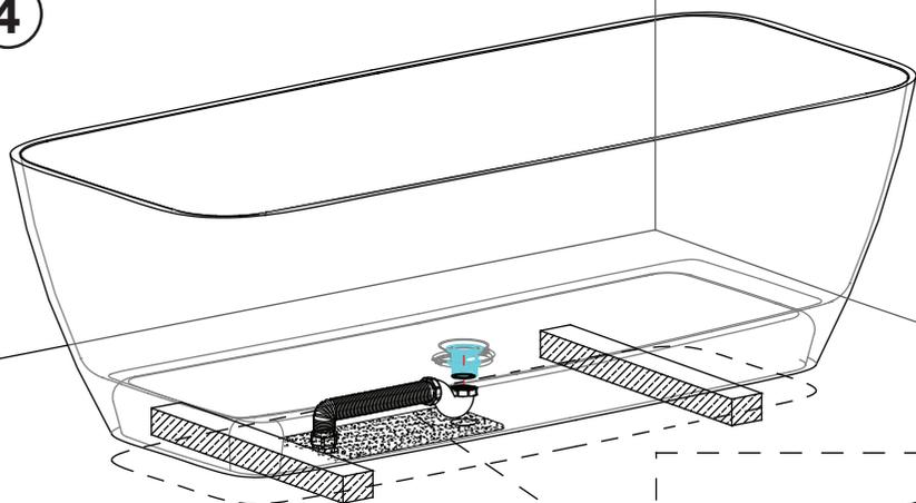
Placez la baignoire sur deux blocs en bois au-dessus des raccords aux eaux usées. Raccordez le vidage. Remplissez la baignoire et vérifiez qu'il n'y ait pas de fuites.
